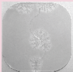
圖一：藥物羅替高停 (Rotigotine) 的結晶體形成於紐普羅® (Neupro®) 貼片內
